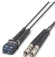
Cavo FO confezionato, cavo break out, fibra polimerica 980/1000  $\mu\text{m}$ , SC-RJ/IP20 su FSMA/IP20, per la posa all'interno di quadri elettrici, cavo adatto all'impiego esterno con protezione UV, lunghezza: 1 m
