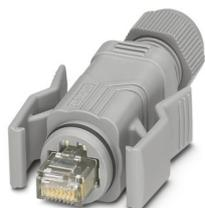
Connettore RJ45, tipo: RJ45, grado di protezione: IP67, numero poli: 8, 1 Gbit/s, CAT5, materiale: Plastica, tipo di connessione: Connessione rapida IDC, sezione di connessione: AWG 26- 23, uscita cavo: dritto, colore: grigio traffico A RAL 7042, Ethernet
