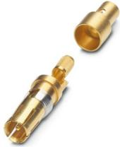
Contatto coassiale, per inserti combinati D-SUB, saldatura a mano, maschio, diritto per cavo RG 179/187, dorato
