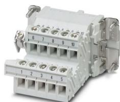
Inserto portacontatti femmina HEAVYCON con adattatore, serie B10, 10 poli, per il lato destro del quadro elettrico, connessione a vite.
