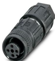
Connettore, Universale, 4-poli, Femmina diritto M12, codifica: A, Connessione a perforazione di isolante, materiale zigrinato: Plastica, diametro esterno conduttore 3,5 mm ... 6 mm
