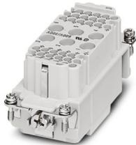
Inserto contatti, numero poli: 6+36+PE, dimensioni: B16, contatti di potenza: 6, contatti di comando: 36, Femmina, Connessione a crimpare, 690 V, 40 A, 1,5 mm<sup>2</sup> ... 6 mm<sup>2</sup>, applicazione: Potenza/segnale
