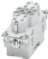
Inserto contatti, numero poli: 6+12+PE, dimensioni: B16, contatti di potenza: 6, contatti di comando: 12, Femmina, Connessione a vite assiale, 690 V, 40 A, 2,5 mm<sup>2</sup> ... 10 mm<sup>2</sup>, applicazione: Potenza/segnale
