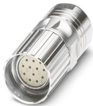
Connettore per cavi, dritto, Bloccaggio a vite, M23, numero poli: 6, tipo di connessione del contatto: Femmina, schermato: sì, diametro cavi: 5 mm ... 13,2 mm, numero poli: 6, tipo di connessione: Attacco a saldare, serie: RF
