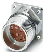
Connettore per apparecchi anteriore, diritto, Bloccaggio a vite, M23, numero poli: 16, tipo di connessione del contatto: Femmina, O-ring assiale, 4x Ø 2,7 mm, schermato: sì, numero poli: 16, tipo di connessione: Connessione a crimpare, serie: RF
