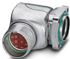
Connettore per apparecchi anteriore, angolato, fisso, Bloccaggio a vite, M23, numero poli: 16, tipo di connessione del contatto: Femmina, O-ring assiale, schermato: sì, misura flangia: 26 mm x 26 mm, numero poli: 16, tipo di connessione: Connessione a crimpare, serie: RF
