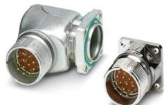
Connettore per apparecchi anteriore, angolato, orientabile, Bloccaggio a vite, M23, numero poli: 16, tipo di connessione del contatto: Spina, O-ring assiale, 4x Ø 3,2, schermato: sì, misura flangia: 28 mm x 28 mm, numero poli: 16, tipo di connessione: Connessione a crimpare, serie: RF
