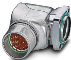
Connettore per apparecchi anteriore, angolato, fisso, Bloccaggio a vite, M23, numero poli: 16, tipo di connessione del contatto: Spina, O-ring assiale, 4x Ø 3,2, schermato: sì, misura flangia: 28 mm x 28 mm, numero poli: 16, tipo di connessione: Connessione a crimpare, serie: RF
