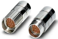
Connettore per giunti, diritto, Bloccaggio a vite, M23, numero poli: 16, tipo di connessione del contatto: Spina, schermato: sì, diametro cavi: 6 mm ... 10 mm, numero poli: 16, tipo di connessione: Connessione a crimpare, serie: RF, Prodotto alternativo secondo RoHS II senza eccezione 6c (Pb < 0,1 %) cod. art.: 1242818
