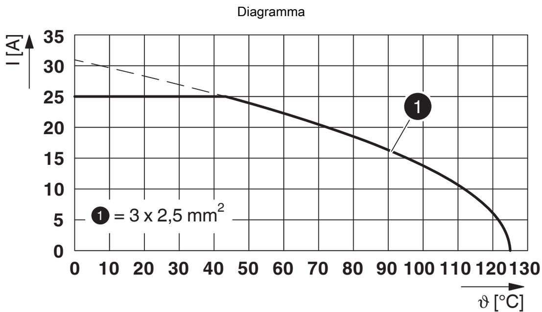
$I$  = intensità di corrente,  $\vartheta$  = temperatura ambiente, 3x 25 A
