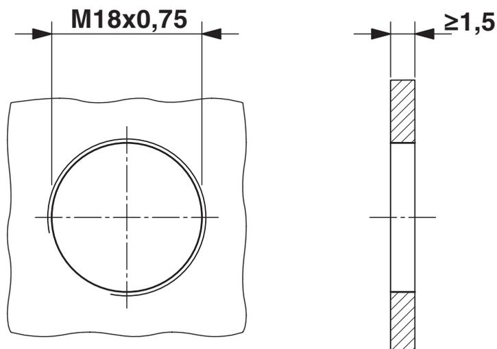
Dimensioni di installazione: montaggio con filettatura
