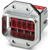
Telaio da incasso MSTB, IP 67, per bloccaggio Push-Pull, metallo, con inserto portacontatti integrato per connessione c.s., connessione a molla 400 V, per sezione di montaggio rettangolare, con guarnizione, senza viti di fissaggio
