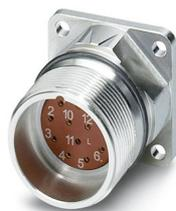
Connettore per apparecchi anteriore, diritto, Bloccaggio a vite, M23, numero poli: 17, tipo di connessione del contatto: Femmina, O-ring assiale, 4x Ø 2,7 mm, schermato: sì, numero poli: 17, tipo di connessione: Connessione a crimpare, serie: RF
