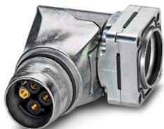
Connettore per apparecchi anteriore, angolato, orientabile, SPEEDCON, M17, numero poli: 7+PE, tipo di connessione del contatto: Femmina, O-ring assiale, 4x Ø 2,7 mm, schermato: sì, misura flangia: 25 mm x 25 mm, numero poli: 8, tipo di connessione: Connessione a crimpare, serie: ST
