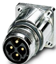
Connettore per apparecchi anteriore, diritto, per bloccaggio standard e SPEEDCON, M17, numero poli: 3+PE, tipo di connessione del contatto: Spina, O-ring assiale, schermato: sì, misura flangia: 21,6 mm x 21,6 mm, numero poli: 4, tipo di connessione: Connessione a crimpare, serie: ST
