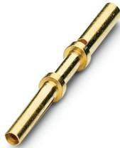
Contatto a crimpare, Femmina, tornito, diametro contatti: 0,6 mm, sezione di connessione: 0,14 mm<sup>2</sup> ... 0,34 mm<sup>2</sup>, materiale contatti: CuZn , Prodotto alternativo secondo RoHS II senza eccezione 6c (Pb < 0,1 %) cod. art.: 1242314
