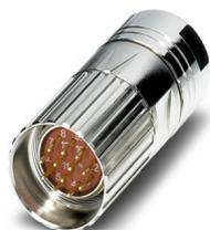
Connettore per cavi, diritto, Bloccaggio a vite, M23, numero poli: 17, tipo di connessione del contatto: Spina, schermato: sì, diametro cavi: 9 mm ... 13,2 mm, numero poli: 17, tipo di connessione: Connessione a crimpare, serie: RF
