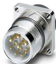
Connettore per apparecchi anteriore, formato sottile diritto, Bloccaggio a vite, M23, numero poli: 5+PE, tipo di connessione del contatto: Spina, O-ring assiale, schermato: sì, misura flangia: 28 mm x 28 mm, diametro cavi: 0 mm ... 0 mm, numero poli: 6, tipo di connessione: Connessione a crimpare, serie: SF
