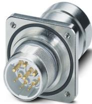
Passaparete posteriore, diritto, Bloccaggio a vite, M23, numero poli: 5+PE, tipo di connessione del contatto: Spina, O-ring assiale, schermato: sì, diametro cavi: 9 mm ... 11 mm, numero poli: 6, tipo di connessione: Connessione a crimpare, serie: SF, questo articolo dovrebbe essere privo di piombo dal primo trimestre 2027 secondo la RoHS II senza l'eccezione 6c (Pb < 0,1 %), un'alternativa priva di piombo è disponibile in anticipo su richiesta
