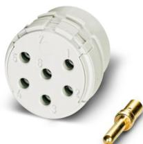
Inserto contatti, M23, numero poli: 8+1, tipo di connessione del contatto: Spina, Connessione a crimpare, serie: NC, RC, RM, TU, UC, Prodotto alternativo secondo RoHS II senza eccezione 6c (Pb < 0,1 %) cod. art.: 1242202
