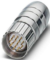
M23, Connettore per cavi, serie: UC, diritto, schermato: sì, Bloccaggio a vite, Numero di poli: 6, Senso di rotazione: standard, tipo di connessione del contatto: Spina, A saldare a mano, diametro cavi: 2 mm ... 14,5 mm, codifica: N
