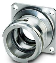
Custodia per connettore circolare, serie: TU, diritto, Bloccaggio a baionetta, M23, numero poli: 12, tipo di connessione del contatto: Femmina, Connessione a crimpare, O-ring radiale, schermato: sì, spessore della parete min.: 3,5 mm
