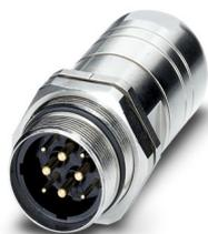
Passaparete posteriore, diritto, corto, Bloccaggio a vite, M40, numero poli: 4+3+PE, tipo di connessione del contatto: Spina, O-ring assiale, Fissaggio centrale, schermato: sì, diametro cavi: 17 mm ... 21 mm, numero poli: 8, tipo di connessione: Connessione a crimpare, serie: SM
