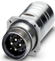
Passaparete posteriore, diritto, corto, Bloccaggio a vite, M40, numero poli: 4+3+PE, tipo di connessione del contatto: Spina, O-ring assiale, schermato: sì, diametro cavi: 9 mm ... 12,5 mm, numero poli: 8, tipo di connessione: Connessione a crimpare, serie: SM, questo articolo dovrebbe essere privo di piombo dal primo trimestre 2027 secondo la RoHS II senza l'eccezione 6c (Pb < 0,1 %), un'alternativa priva di piombo è disponibile in anticipo su richiesta
