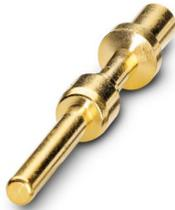
Contatto a crimpare, Spina, tornito, diametro contatti: 3,6 mm, sezione di connessione: 2,5 mm<sup>2</sup> .. 4 mm<sup>2</sup>, materiale contatti: CuZn , Prodotto alternativo secondo RoHS II senza eccezione 6c (Pb < 0,1 %) cod. art.: 1241976
