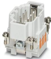
Inserto contatti, numero poli: 6+PE, dimensioni: B6, numero di connessioni per polo: 1, Spina, Attacco QUICKON, 500 V, 16 A, 0,34 mm<sup>2</sup> ... 2,5 mm<sup>2</sup>
