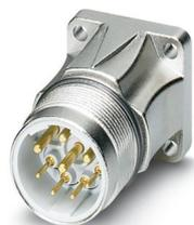
Connettore per apparecchi anteriore, diritto, per bloccaggio standard e SPEEDCON, M23, numero poli: 5+PE, tipo di connessione del contatto: Spina, O-ring assiale, schermato: sì, misura flangia: 26 mm x 26 mm, Compatibile con contro connettori con dado zigrinato standard M23 o SPEEDCON, numero poli: 6, tipo di connessione: Connessione a crimpare, serie: SF
