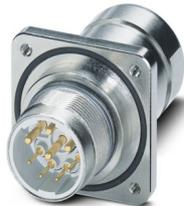
Passaparete posteriore, diritto, Bloccaggio a vite, M23, numero poli: 5+PE, tipo di connessione del contatto: Spina, O-ring assiale, schermato: sì, diametro cavi: 7,5 mm ... 14 mm, numero poli: 6, tipo di connessione: Connessione a crimpare, serie: SF, questo articolo dovrebbe essere privo di piombo dal primo trimestre 2027 secondo la RoHS II senza l'eccezione 6c (Pb < 0,1 %), un'alternativa priva di piombo è disponibile in anticipo su richiesta
