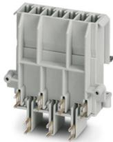
DUPLICON, inserto portacontatti da incasso, 6 x 4 mm<sup>2</sup> + PE, 400/690 V, 25 A, collegamento al circuito stampato a 90°, versione B6, grado di protezione IP20
