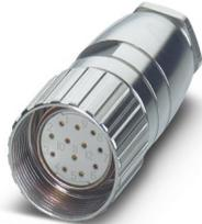
M23, Connettore per cavi, serie: RC, diritto, schermato: no, Bloccaggio a vite, Numero di poli: 8+1, Senso di rotazione: standard, tipo di connessione del contatto: Femmina, A saldare a mano, codifica: N, questo articolo dovrebbe essere privo di piombo dal quarto trimestre 2025 secondo la RoHS II senza l'eccezione 6c (Pb < 0,1 %), un'alternativa priva di piombo è disponibile in anticipo su richiesta
