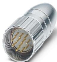
M23, Connettore per cavi, diritto, Bloccaggio a vite, Numero di poli: 8+1, Senso di rotazione: standard, tipo di connessione del contatto: Spina, A saldare a mano, diametro cavi: 5,5 mm ... 6,5 mm, codifica: N
