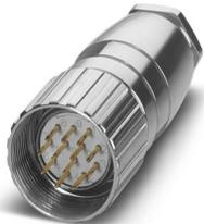
M23, Connettore per cavi, serie: RC, diritto, schermato: no, Bloccaggio a vite, Numero di poli: 8+1, Senso di rotazione: standard, tipo di connessione del contatto: Spina, A saldare a mano, codifica: N, questo articolo dovrebbe essere privo di piombo dal quarto trimestre 2025 secondo la RoHS II senza l'eccezione 6c (Pb < 0,1 %), un'alternativa priva di piombo è disponibile in anticipo su richiesta
