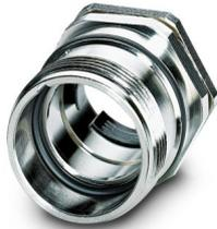
Custodia per connettore circolare, serie: RC, diritto, Bloccaggio a vite, M23, O-ring assiale, schermato: sì, spessore della parete min.: 0,8 mm, spessore della parete max.: 6,5 mm, questo articolo dovrebbe essere privo di piombo dal primo trimestre 2026 secondo la RoHS II senza l'eccezione 6c (Pb < 0,1 %), un'alternativa priva di piombo è disponibile in anticipo su richiesta
