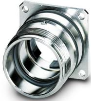
Custodia per connettore circolare, serie: RC, diritto, Bloccaggio a vite, M23, O-ring radiale, schermato: sì, spessore della parete min.: 2,7 mm, spessore della parete max.: 3,5 mm, questo articolo dovrebbe essere privo di piombo dal terzo trimestre 2026 secondo la RoHS II senza l'eccezione 6c (Pb < 0,1 %), un'alternativa priva di piombo è disponibile in anticipo su richiesta
