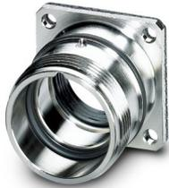
Custodia per connettore circolare, serie: RC, diritto, Bloccaggio a vite, M23, Guarnizione piatta, schermato: sì, misura flangia: 25 mm x 25 mm, spessore della parete min.: 1 mm, questo articolo dovrebbe essere privo di piombo dal secondo trimestre 2026 secondo la RoHS II senza l'eccezione 6c (Pb < 0,1 %), un'alternativa priva di piombo è disponibile in anticipo su richiesta
