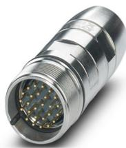
Connettore per giunti, diritto, Bloccaggio a vite, M27, numero poli: 26, tipo di connessione del contatto: Spina, schermato: sì, grado di protezione: IP67, diametro cavi: 2 mm ... 14,5 mm, numero poli: 26, tipo di connessione: A saldare a mano, serie: HC, questo articolo dovrebbe essere privo di piombo dal secondo trimestre 2026 secondo la RoHS II senza l'eccezione 6c (Pb < 0,1 %), un'alternativa priva di piombo è disponibile in anticipo su richiesta
