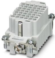
Inserto contatti, numero poli: 42+PE, dimensioni: B10, numero di connessioni per polo: 1, Femmina, Connessione a crimpare, 250 V, 10 A, 0,14 mm<sup>2</sup> ... 2,5 mm<sup>2</sup>, applicazione: Segnale
