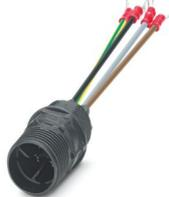
Passaparete QUICKON 3+PE poli, 1,0 mm<sup>2</sup> ... 2,5 mm<sup>2</sup> / 630 V / 20 A, senza dado QUICKON, con 4 fili di conduttore saldati da 1,5 mm<sup>2</sup>, lunghezza 0,1 m, con capocorda ad anello all'estremità
