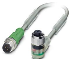
Cavo sensore/attuatore, 4-poli, PUR senza alogenati, resistente agli spruzzi di saldatura, altamente flessibile, grigio RAL 7001, Maschio diritto M12, codifica: A, con 3 LED, su Connettore femmina angolato M12, codifica: A, con 3 LED, lunghezza cavo: 0,6 m, per robot e catene portacavi
