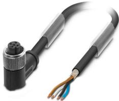
Cavo sensore/attuatore, 4-poli, PUR senza alogenati, grigio RAL 7001, schermata (Advanced Shielding Technology), estremità conduttore libera, su Connettore femmina angolato M12, codifica: A, lunghezza cavo: 5 m
