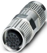
Connettore, Universale, 17-poli, Femmina diritto M12 SPEEDCON, codifica: A, Connessione rapida Piercecon®, materiale zigrinato: Pressogetto di zinco, nichelato, diametro esterno conduttore 5,4 mm ... 8,2 mm
