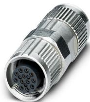
Connettore, Universale, 12-poli, Femmina diritto M12 SPEEDCON, codifica: A, Connessione rapida Piercecon®, materiale zigrinato: Pressogetto di zinco, nichelato, diametro esterno conduttore 5,4 mm ... 8,2 mm
