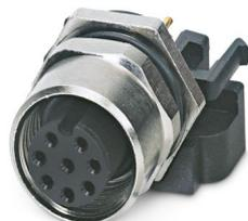
Connettore femmina da incasso sensore-attuatore, 8 poli, M12, codifica A, montaggio posteriore/a vite con filettatura M12, con protezione contro la torsione, connessione a saldare diritta
