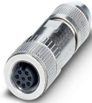
Connettore dati, Ethernet CAT5 (1 Gbit/s), 8-poli, schermata, Femmina diritto M12, codifica: A, Connessione a perforazione di isolante, materiale zigrinato: Ottone, nichelato, diametro esterno conduttore 4 mm ... 8 mm
