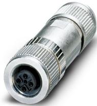
Connettore dati, Ethernet CAT5 (100 MBit/s), 4-poli, schermata, Femmina diritto M12, codifica: D, Connessione a perforazione di isolante, materiale zigrinato: Ottone, nichelato, diametro esterno conduttore 4 mm ... 8 mm
