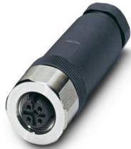
Connettore, Universale, 5-poli, Femmina diritto M12, codifica: A, Connessione a vite, materiale zigrinato: Acciaio legato 1.4404, connessione a vite per cavo Pg9, diametro esterno conduttore 6 mm ... 8 mm
