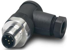
Connettore, Universale, 5-poli, Maschio angolato M12, codifica: A, Connessione a vite, materiale zigrinato: Acciaio legato 1.4404, connessione a vite per cavo Pg7, diametro esterno conduttore 4 mm ... 6 mm
